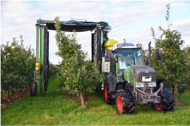
Abb. 5 Parzellensprühgerät LIPCO OSG-N1 (P.A.U.L.) mit aktiver Abdriftminderung (Tunneltechnik).
