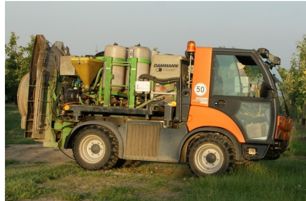
Abb. 6 Parzellensprühgerät mit Wanner ZA32 (KURT), konventionelle Pflanzenschutztechnik (Axialgebläse mit Querstromaufsatz).
